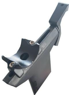
Quando a placa de base da abraçadeira do selim é totalmente empurrada para a frente, não é possível estender/ampliar a placa.
