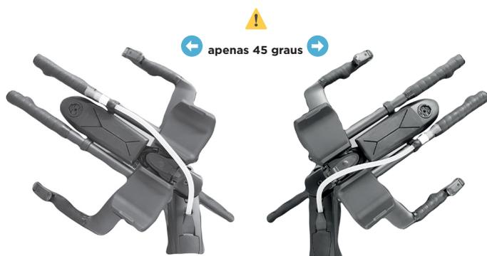
Ao utilizar, transportar ou armazenar a sua Plasma 6, tenha em atenção a rotação limitada dos guiadores e da forqueta. Não os force após uma rotação de 45 graus.
