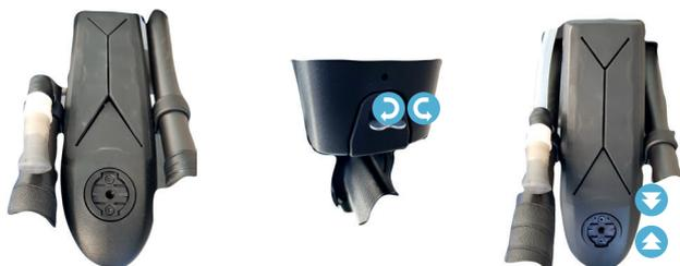
A Caixa de Nutrição entre os extensores do guidador pode ser inclinada para baixo para que possa fixar uma unidade de GPS maior.
