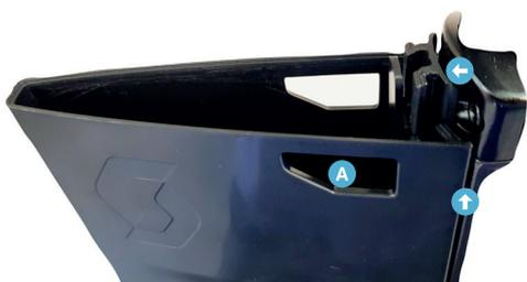
Pode aceder à Caixa de Armazenamento atrás do tubo do selim pressionando os pontos **A** na tampa de ambos os lados (tampa não apresentada na imagem).
