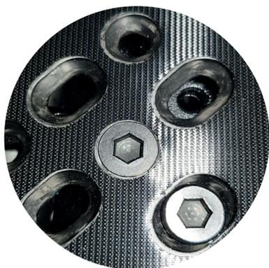
⚠ Aperte apenas dois parafusos a 5 Nm, com a adição de Blue Loctite.
