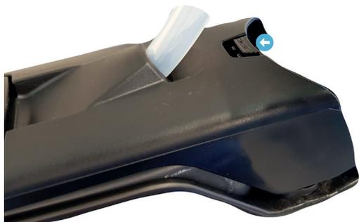
O Bidon de Hidratação do Tubo Superior pode ser retirado do quadro pressionando suavemente. ➔.
