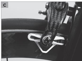
O aro pode ficar danificado e a câmara de ar pode rebentar, provocando um acidente. Desacelere, em princípio, ativando os dois travões, depois largue durante algum tempo até voltar a travar. Vá sempre alternando, permitindo que o material arrefeça. Se sentir insegurança, pare a bicicleta e deixe arrefecer.
