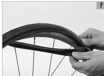
Nos aros com base dupla, os chamados aros de parede dupla, ela tem de ficar esticada por toda a base; mas não pode, porém, ser tão larga que fique a sobressair dos flancos. Deveria combinar esses aros apenas com fitas de tecido ou de plástico rígido. Se não estiver absolutamente seguro ou caso tenha perguntas a fazer, é favor dirigir-se ao seu revendedor SCOTT.
