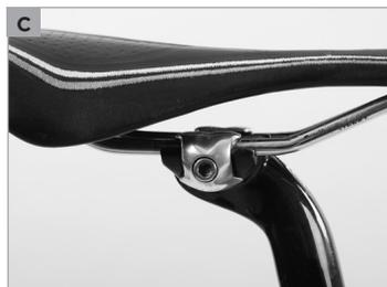
No **sistema de um parafuso (c)** o espigão do selim está concebido para a maior parte dos selins desportivos com um diâmetro do tubo da armação do selim de 7 mm.
