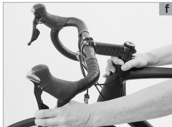
Para examinar a facilidade de viragem da caixa, levante o quadro com uma mão, até a roda dianteira deixar de ter contacto com o solo. A roda dianteira tem de poder rodar sem encaixar, do ponto mais à esquerda para o ponto mais à direita. Se tocar ao de leve no guiador, o garfo tem de rodar sozinho a partir da sua posição central **(a)**.
