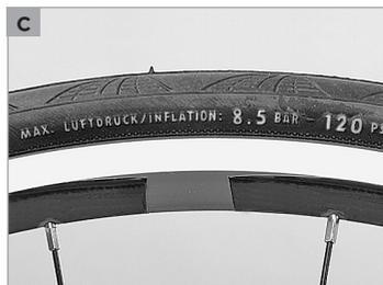
Pneus com armação de arame ou kevlar não são, por si, herméticos com o aro. Para manter a pressão no interior, é colocada uma câmara de ar **(f)** e insuflado através de uma válvula.
