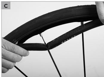
Certifique-se de que a câmara de ar não fica presa entre o pneu e o aro e é esmagada. Vá empurrando com a mão a câmara de ar continuamente para o interior do pneu **(c)**.
