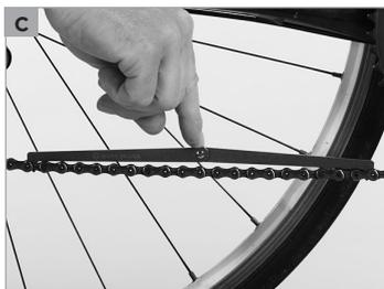
Substituir estes componentes é caro em comparação com a substituição da corrente. Controle, por isso, regularmente, o estado da corrente.
