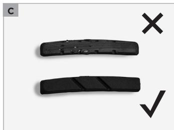
Inspecções regulares e a substituição oportuna de peças de desgaste, p. ex. correntes, calços dos travões **(c)** ou cabos de travões e mudanças **(d)**, fazem parte do uso apropriado da sua bicicleta SCOTT.
