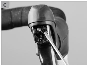
Na **SRAM** ajuste primeiro os discos de cames nas manetes de mudanças, metidas um pouco para dentro e rodadas. Depois disso, rode para dentro o parafuso que está escondido por baixo da borracha da manete dentro do corpo com uma chave allen **(e)**.
