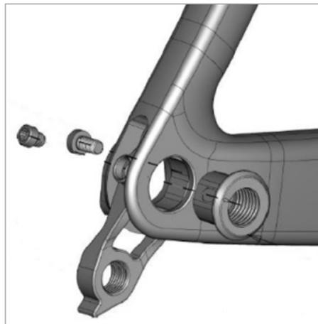
Ao instalar o dropout, certifique-se que a seta branca no adaptador roscado é instalado alinhado com o parafuso traseiro conforme a imagem abaixo.
