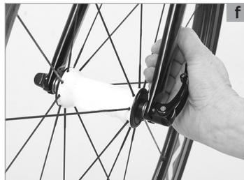
Depois, a força de resistência da alavanca deverá aumentar significativamente e, no final, a alavanca só se deverá poder mover com muito esforço. Use o tenar do polegar e puxe, se necessário, também com os outros dedos, um componente fixo, por exemplo, o garfo **(f, p. 33)** ou a escora traseira, mas não um disco de travão ou raio.
